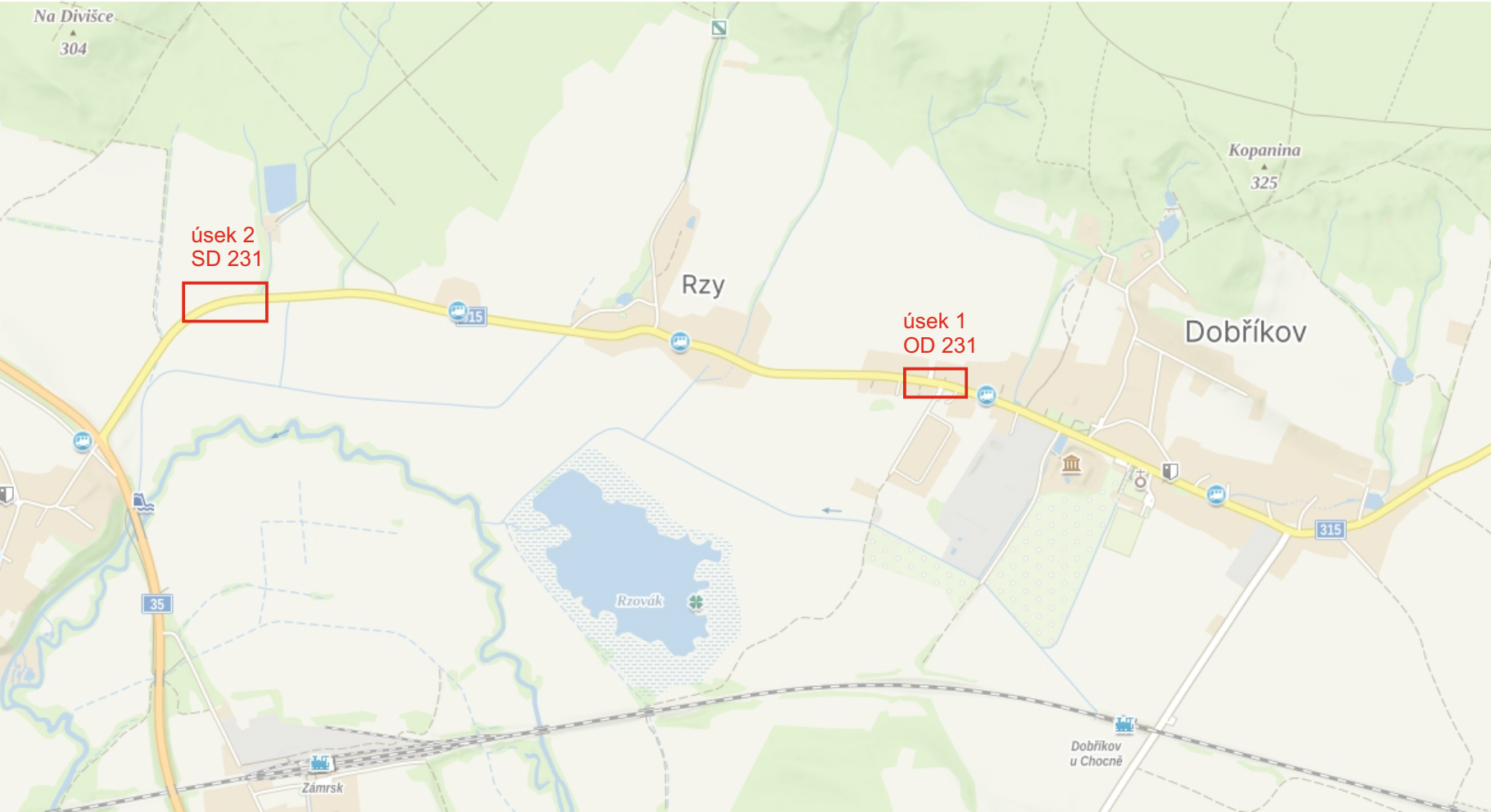
úsek 1, schéma OD 231: pravý jízdní pruh, směr na Rzy, průjezdní šíře 2,8m
