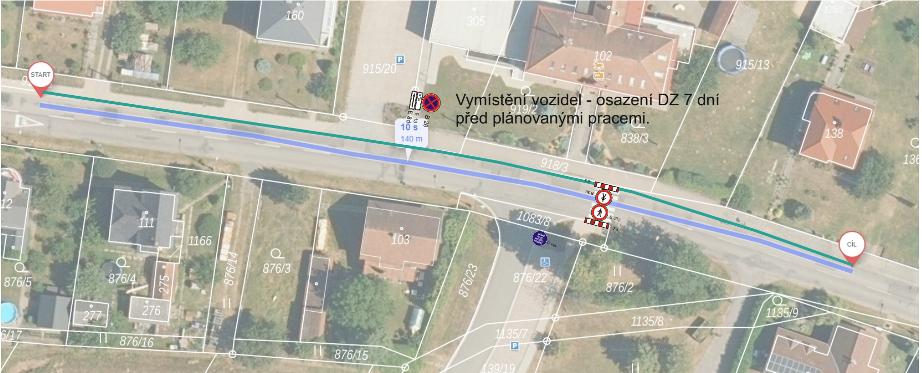
úsek 1, schéma OD 231: pravý jízdní pruh, směr na Rzy, průjezdní šíře 2,8m
