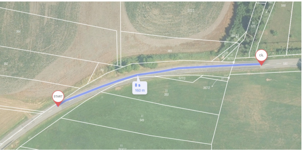
úsek 2, schéma SD 231: oba jízdní pruhy, práce budou probíhat po 1/2, průjezdní šíře 2,8m
